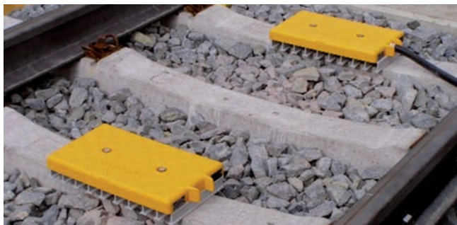
Obr. 2 Balizová skupina tvorená jednou neprepínateľnou (vľavo) a jednou prepínateľnou (vpravo) balízou. Zdroj [7]
