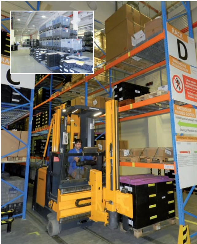
Obr. 2 Pôvodné riešenie skladu hotových výrobkov (hore) a súčasný stav s využitím vozíkov VNA
