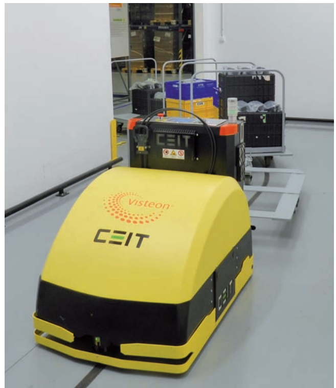
Obr. 3 Vozík AGV na svojej ceste zo skladu surového materiálu
