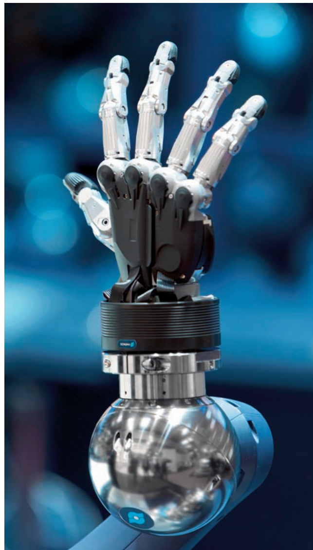
Inteligentný uchopovací systém, ktorý sa skladá z odľahčeného ramena SCHUNK LWA 4P Powerball a multifunkčnej päťprstovej uchopovacej ruky SCHUNK SVH bude čoskoro k dispozícii v silovo riadenej intuitívne programovateľnej verzii na báze ROSu
